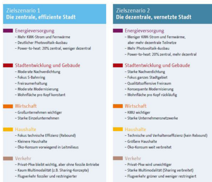
Abbildung 7.1.4a: Schlüsselfaktoren der beiden Zielszenarien nach Handlungsfelder in der Übersicht; Darstellung: Machbarkeitsstudie Berlin, 2014)
