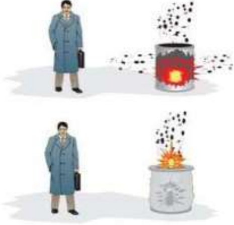
Abbildung 14 verschiedene Mülleimerbauweisen bei Explosionen (©FTA 2004, S. 3–9)
